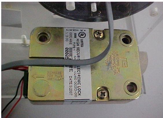
Parafusos de fixação da fechadura
